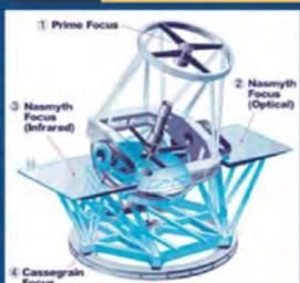
Les plus récentes générations de télescopes adoptent le schéma que l'ingénieur *Nasmyth* inventa en 1842. Un troisième miroir réfléchit le faisceau lumineux vers un oculaire fixe permettant l'utilisation d'appareillages lourds et interchangeables.
