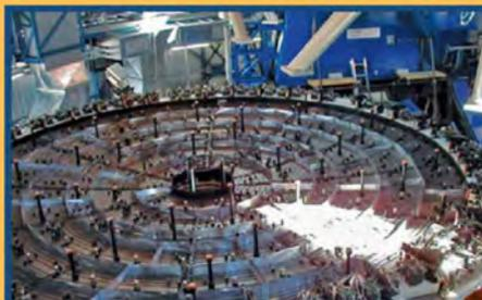
L'atmosphère déforme les ondes lumineuses qui nous parviennent. Grâce à la technique de l'optique adaptative on peut corriger ces défauts en déformant le miroir primaire posé sur de nombreux vérins. Sur la photo, on peut voir le berceau qui reçoit le miroir principal du VLT et les vérins qui permettent en temps réel, d'obtenir des images d'une grande netteté.
