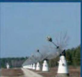
Vue des antennes Nord-Sud du Radiohéliographe de Nançay, réseau interférométrique, spécialisé dans les images de la couronne solaire.
