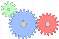
**1. Ces trois roues sont coplanaires. Si la roue rose (celle de droite) fait un tour dans le sens trigonométrique, combien de tours fait la roue verte (celle de gauche) et dans quel sens ?**
